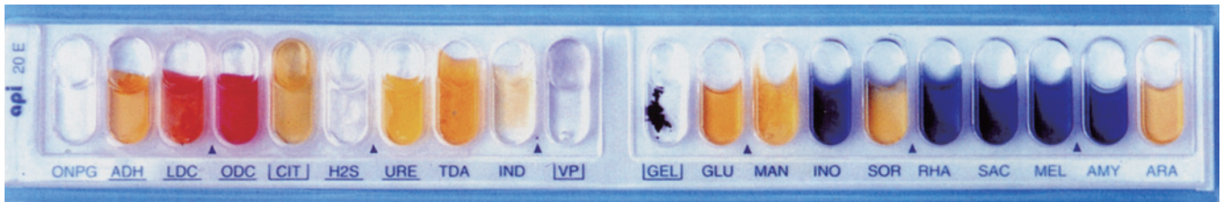
図 14. アピ 20E における S. Abortusequi 北大株の反応：37°C 24 時間培養後。
