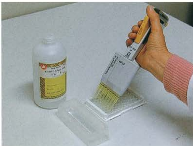
10) 発色停止液を50 \mu lづつ入れる。既に入っている発色液にチップの先端が触れないようにする。
