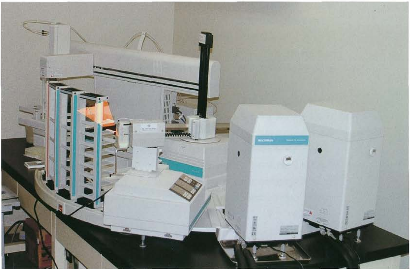
JRAトレーニングセンターで使用しているエライザ用のロボット。血清試料および試薬類をセットすると、すべての反応が自動的に行われ、成績がプリントアウトされる。
