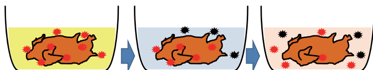
1. 消毒薬に浸漬 2. 消毒薬の除去あるいは消毒薬の効果の停止処置 3. スワブ・リンス・乳剤法による細菌の回収
